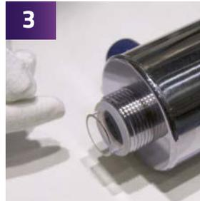
3 Inserte el tubo de cuarzo en la cámara del reactor.
