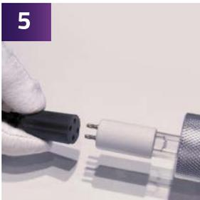
5 Conecte firmemente el portalámparas con las clavijas de la lámpara ultravioleta. (ver detalle pag. 11)
