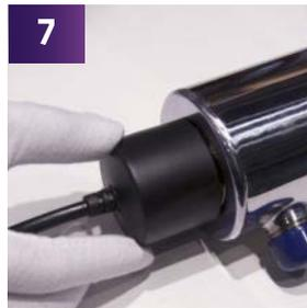
7 Instale la tapa y apriétela manualmente sobre la tuerca del extremo abierto.
